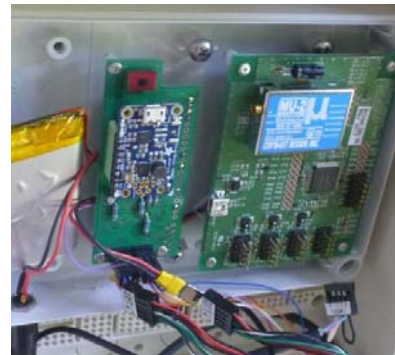
図-1 地中温度MEMSと親機データロガー内部写真(MU-2/Smart Analog)
