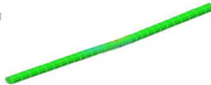
(b) ダウエルバーの最大主応力 (41.4 MPa)
