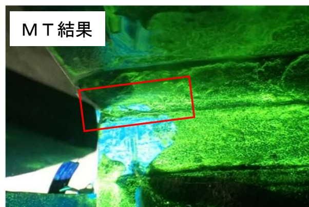
端補剛材・上フランジ溶接部の発生き裂: 支間側
