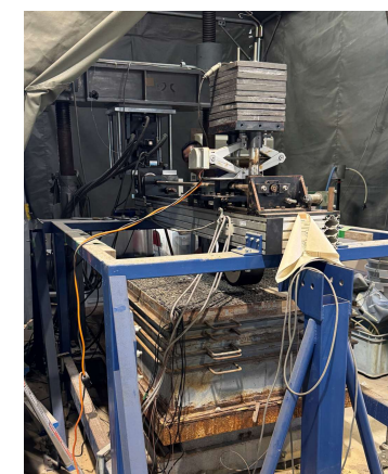
輪荷重走行試験（大型WT試験）
