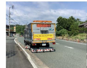
路面下空洞調査実施状況
