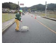
わだち掘れ量調査
