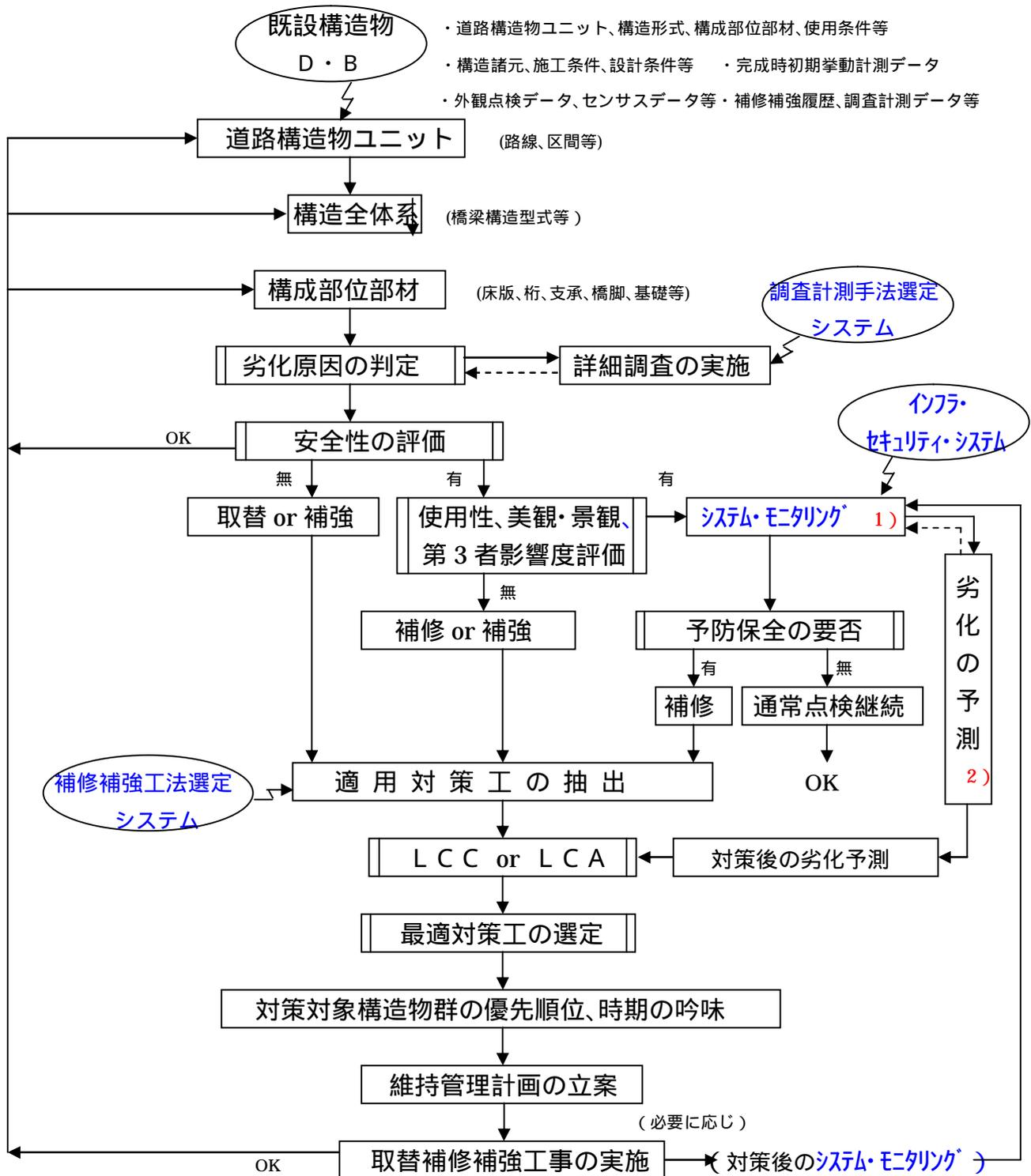
1) 「システム・モニタリング」とは既設橋の劣化要因に着目した遠隔・自動で継続的に行う（劣化診断のための）リアルタイム監視計測をいう。
