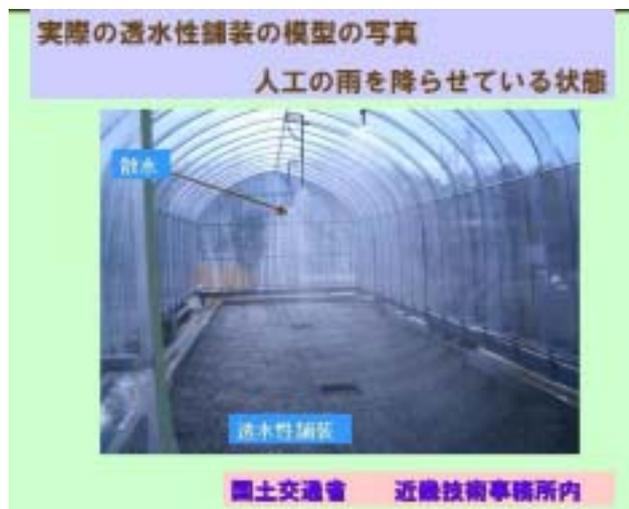
図 - 6 透水性舗装実物模型
