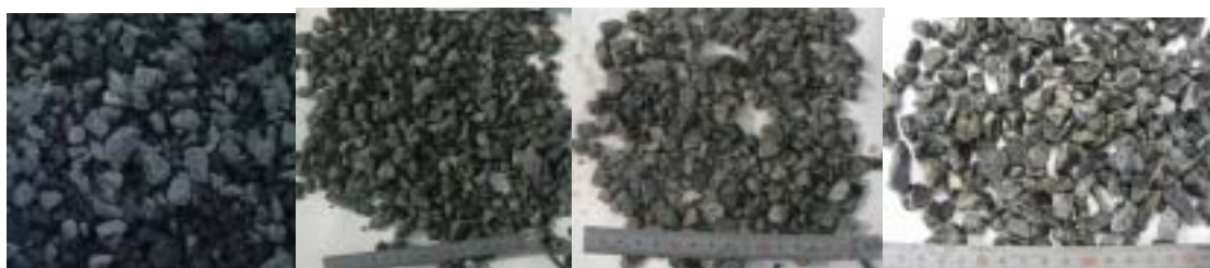
投入切削材 水準 1 での再生粗骨材 水準 2 での再生粗骨材 水準 3 での再生粗骨材 写真 4-3 投入切削材と再生粗骨材の状態
