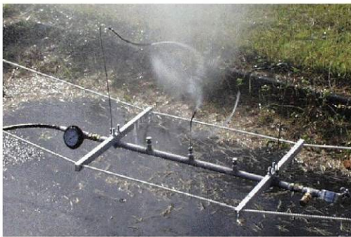
チューブノズルの簡易洗浄装置
