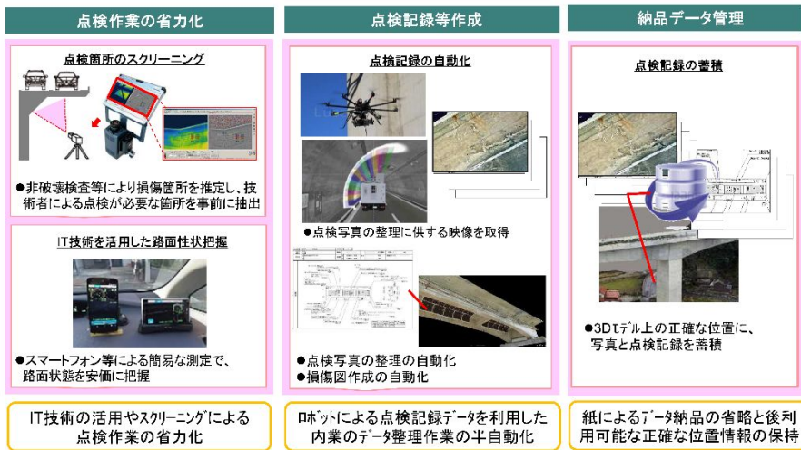
図3. i-constructionによる先進的なインフラ点検支援技術の利用
