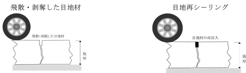
図-3.1.1 対象損傷と目地再シーリング
