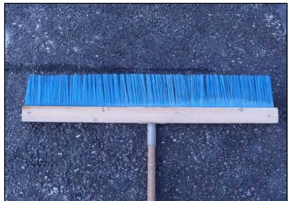
写真-3.8.9 フロートによる平坦仕上げと粗面仕上げ用ホウキの例
