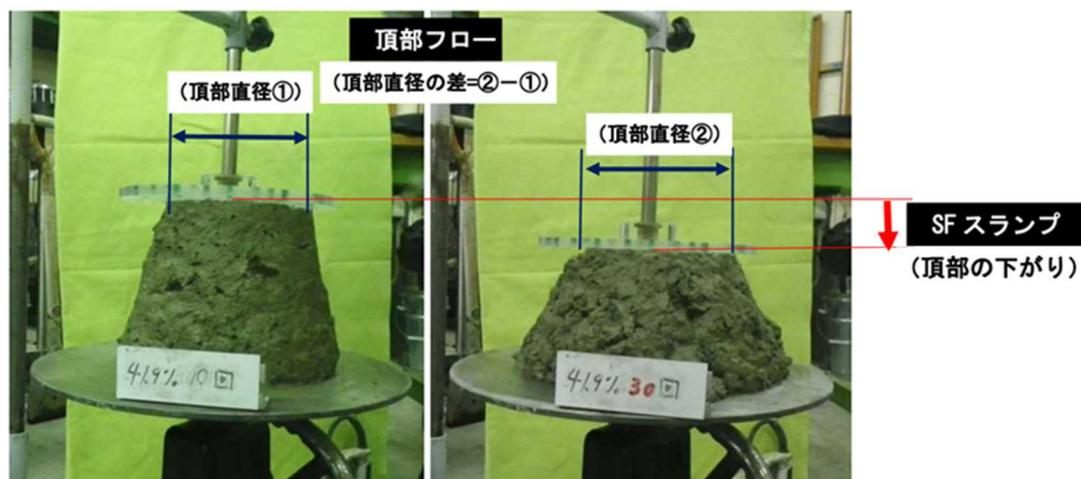
図-2.3.1 テーブルフロー試験の SF スランプと頂部フロー
