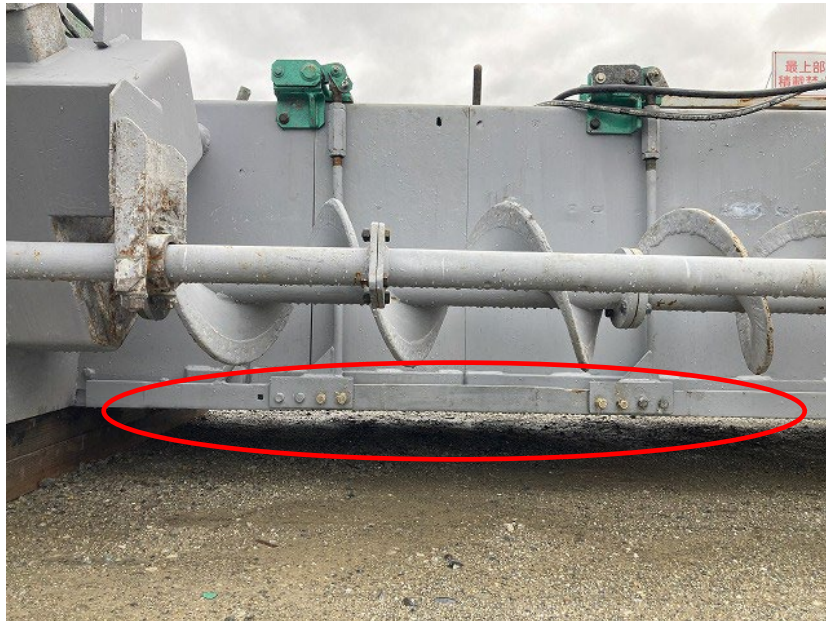
写真 2.2 スリップフォームペーバのタンパの例
