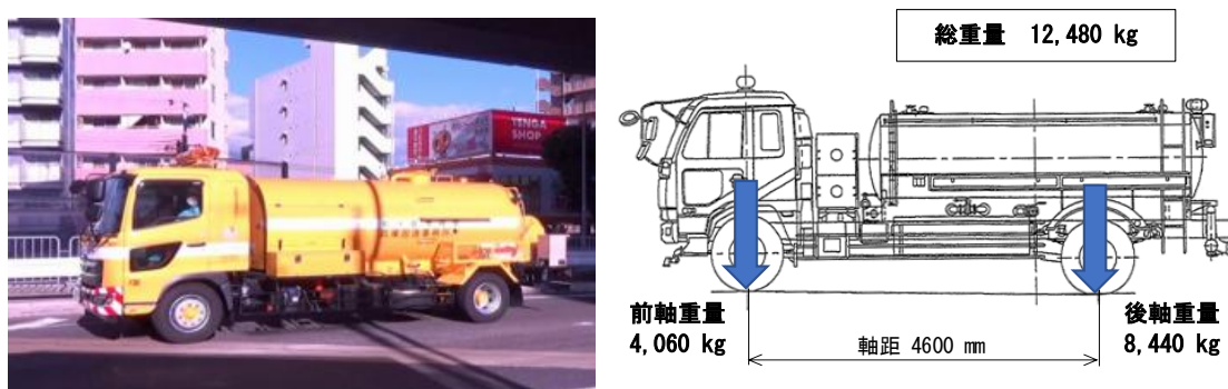
付図4.6 試験車両（排水管清掃車）
