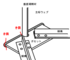
付図3.3 渦電流探傷試験および磁気探傷試験結果（損傷パターン①）
