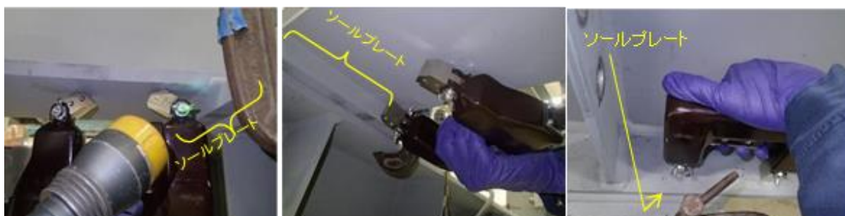
(1)下フランジ下面、ソールプレート (2)下フランジ下面、ソールプレート (3)下フランジ上面から磁化 前面から磁化（溶接線と斜角） 前面から磁化（溶接線に直角） （溶接線を跨いで）
