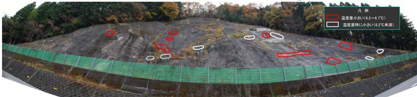
地下水の分布域(水みち等)の推定に、夏期および冬期での2時期の温度差画像を用いて、解析を試みた。その結果、温度変化の小さい部位において、地下水分布域の特定が有効になる可能性が示唆された。
