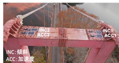
図3 吊り橋主塔の振動および傾斜角計測(電源はソーラパネル)
