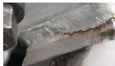
図-2 再現した長い止端き裂とルートき裂
