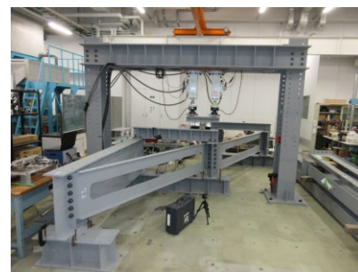
図-1 改良型実物大試験体の载荷状況
