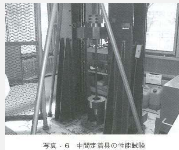
写真 - 6 中間定着具の性能試験
