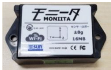
図 3-16 長期モニタリングに導入した WiFi 振動・傾斜計
