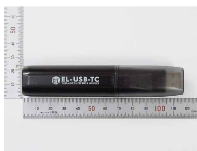
図3-19 長期モニタリングに導入したUSB 熱電対温度ロガー
