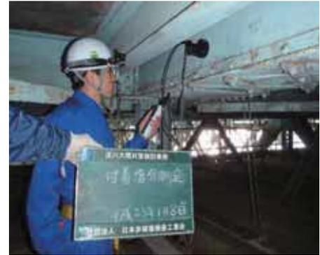
写真2 付着塩分測定状況
