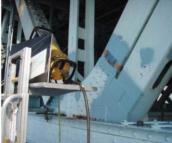
図6 X線透過試験実施状況
