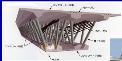
主桁断面パース図
