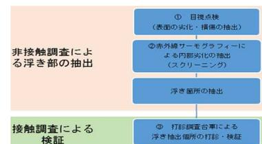
図6 打診点検システムの点検フロー
