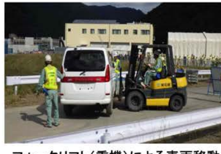
フォークリフト(重機)による車両移動
