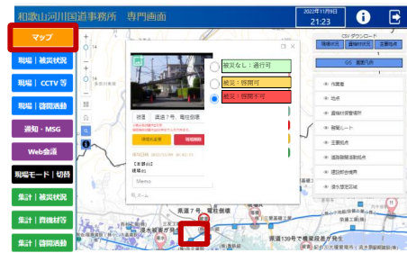
被災状況の共有 (被災状況報告機能)
