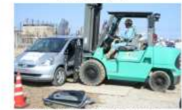
図 路上車両の撤去イメージ
