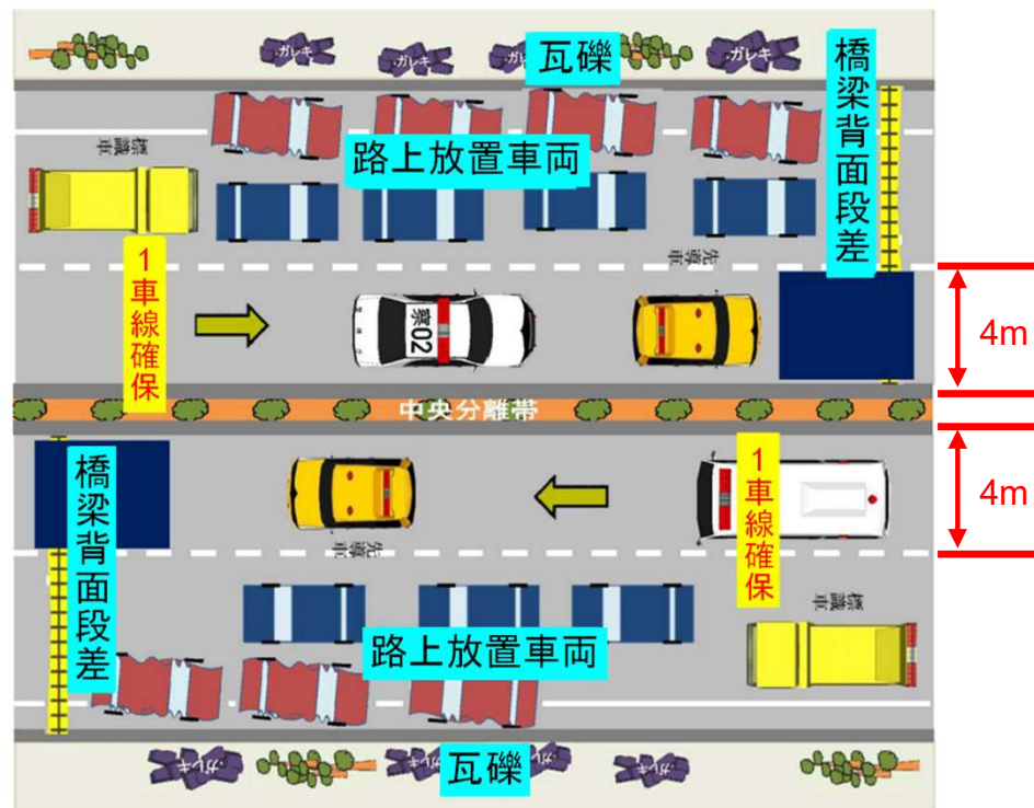
○対面2車線区間の啓開イメージ
