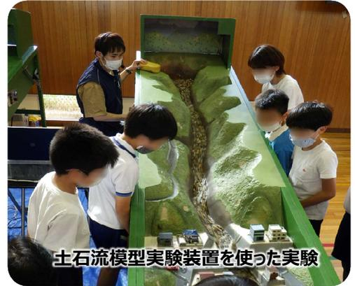
土石流模型実験装置を使った実験
