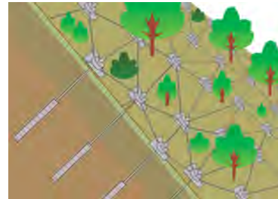
地中に鉄筋やアンカーを入れて崩壊を防ぎます 表土や植生を残すことができる鉄筋挿入工
