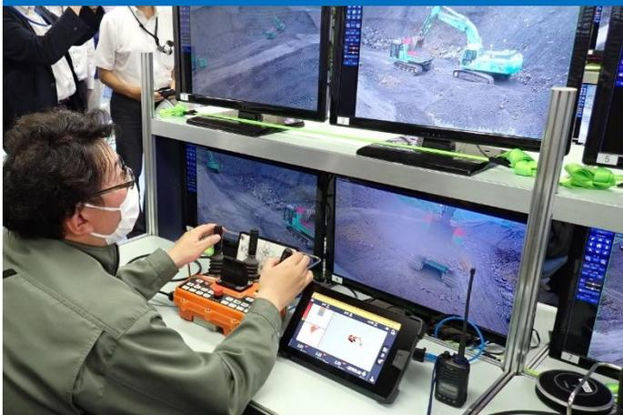
人間が立ち入ることができない危険な作業現場の多い砂防工事現場を支援するため、遠隔操作が可能な建設機械の導入など、最先端の技術が活用されています。
