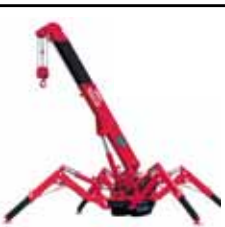
カニクレーン
