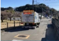
(空洞探査車による調査)
