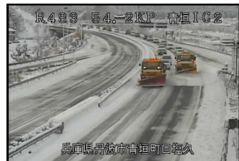
梯団除雪 (除雪トラック)
