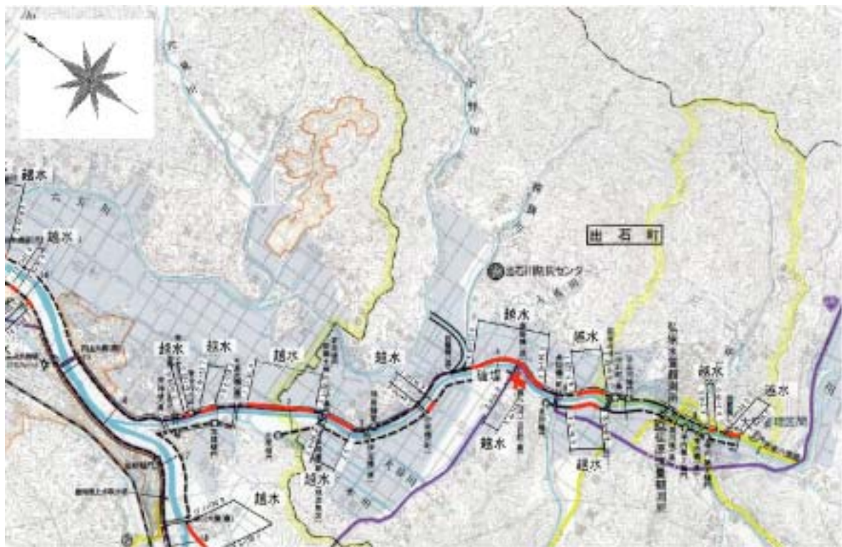
図-2.3.4 痕跡調査による越水区間（出石川）
