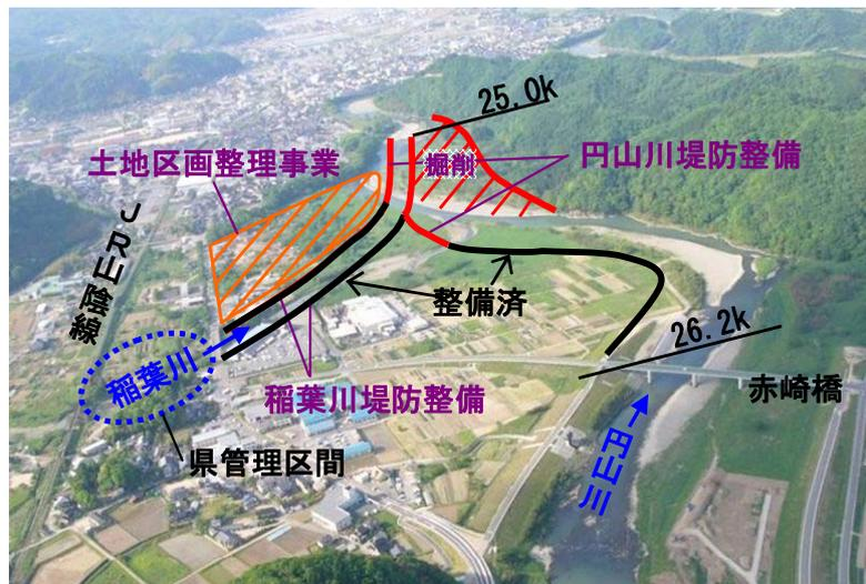
図 4.1.3 稲葉川合流部無堤対策の概要図
