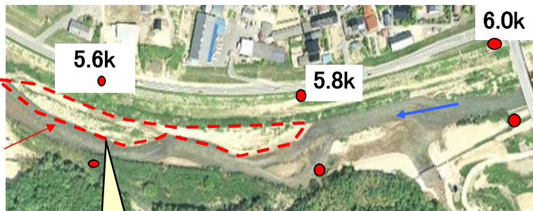
図-1 湾曲部の砂州の発生状況
