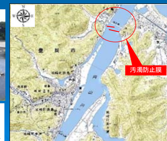
円山川下流の汚濁防止膜設置位置図
