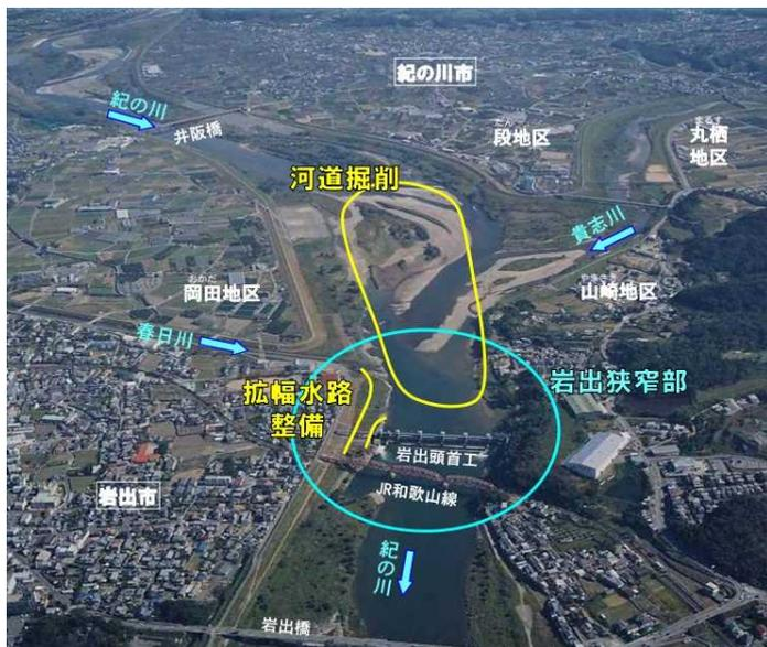
上流部の河道断面と岩出頭首工を拡幅することで、洪水時の水位を低下させます。
