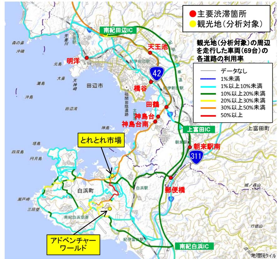
ETC2.0プローブ情報を用いて、観光地(分析対象)から1km以内に進入した車両の移動経路を分析
