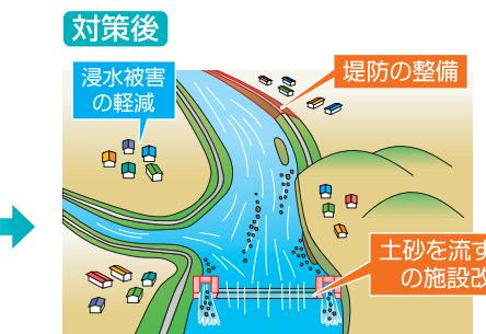
土砂を流すための施設の改修により、堰上流にたまつた土砂が自然に流れ、川の幅や深さが広がり、目標とする洪水に対する浸水被害を軽減します。
