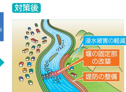
堰の改修により、堰地点において目標とする洪水を安全に流すことができます。また、堰上流にたまつた土砂が自然に流れ、川の幅や深さが広がり、目標とする洪水に対する浸水被害を軽減します。
