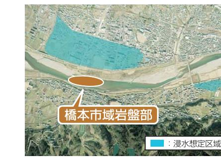
マウンドになっている岩盤部を取り除くことにより、たまつた土砂が自然に流れ、川の幅や深さが広がり、目標とする洪水に対する浸水被害を軽減します。
