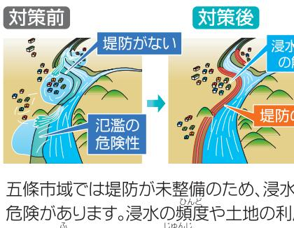
五條市域では堤防が未整備のため、浸水の危険があります。浸水の頻度や土地の利用状況を踏まえながら、順次堤防を整備していく、浸水被害の解消を図ります。
