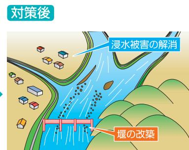
堰の改修により、目標とする洪水を安全に流すことができます。また、堰上流にたまつた土砂が自然に流れ、周辺の浸水被害を解消します。
