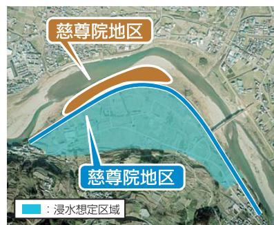
堤防を整備し、土砂を取り除くことにより、浸水被害を解消します。
