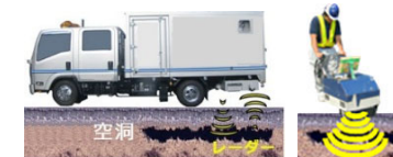
路面下空洞調査
