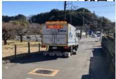
(空洞探査車による調査)
