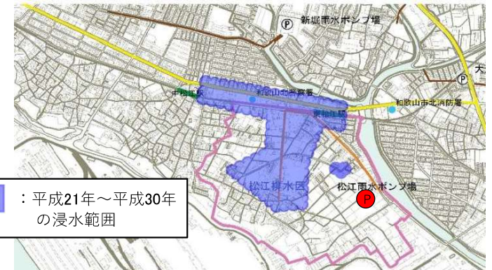
【松江雨水ポンプ場】計画放流量6.9m 3 /s
