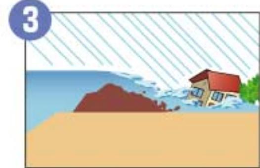
堤防を押しこずして、水が一気に街側に流れ出る。
