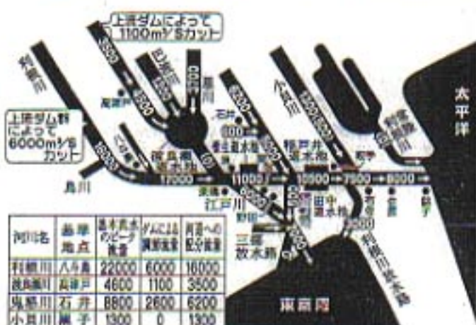
完成にほど近い利根川治水計画( )内は最大合流流量。単位は m^3/S
