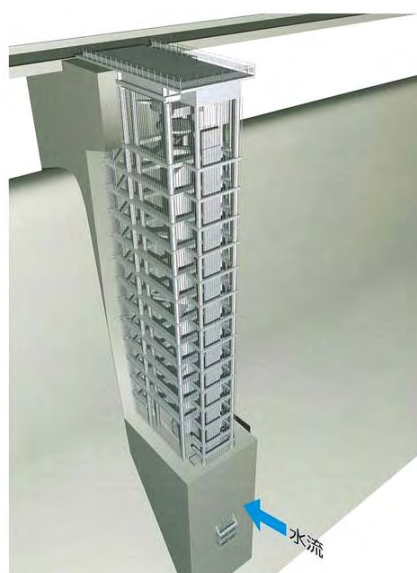
図 2.4.7 大滝ダム-選択取水設備
