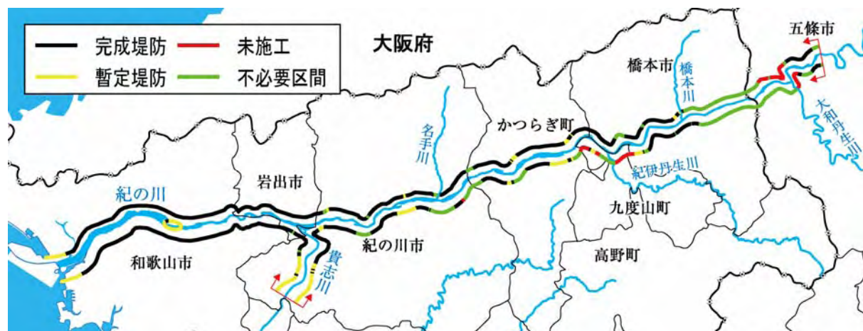
図 2.1.4 堤防整備状況図（平成 23 年 3 月時点）
