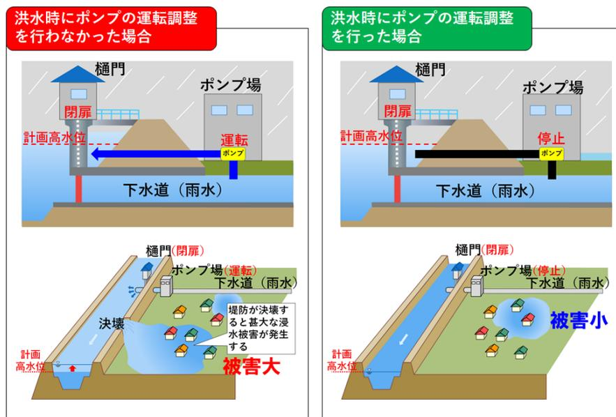
図9 内水排除ポンプの運転イメージ
