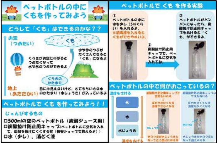
ペットボトル内で雲を作る実験
