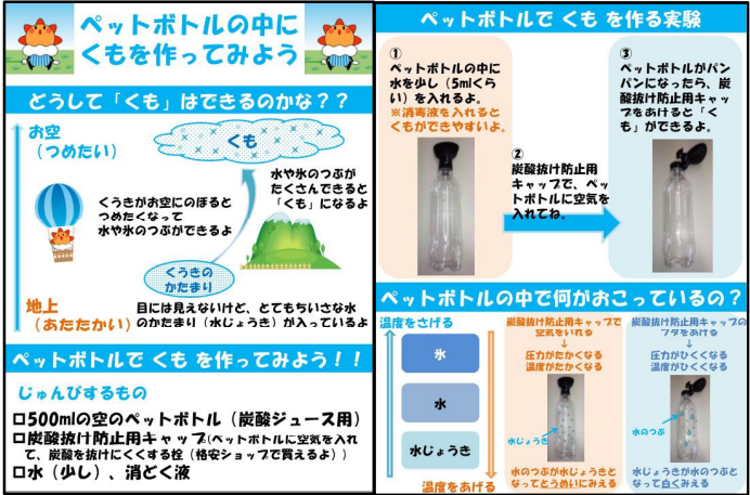
ペットボトル内で雲を作る実験
