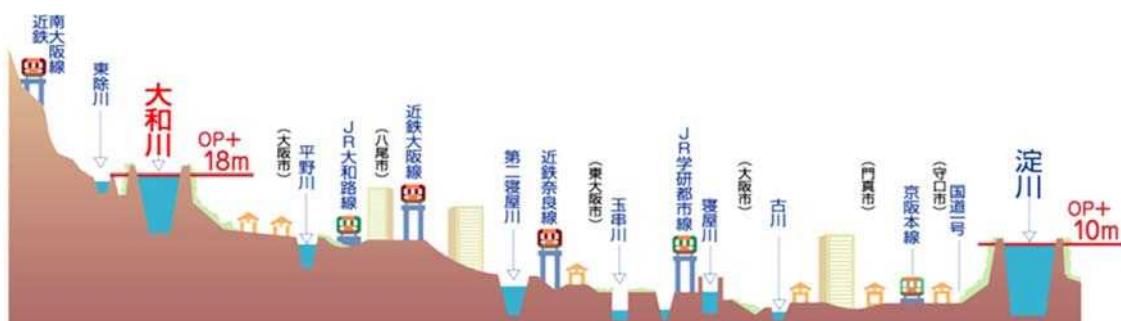
大和川下流部は著しい天井川であり、右岸側の堤防が決壊した場合の氾濫域は広範囲に拡散する。また、左岸側は貯留型の氾濫形態となり、浸水深が大きいといった特徴がある。氾濫域には人口・資産が集積し、一度堤防が決壊すると大都市部が広範囲に浸水し、甚大な社会経済被害を及ぼす等、水害リスクが極めて大きい。
