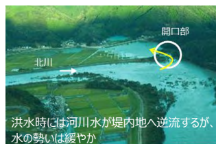
霞堤後背地での貯留(左:五ヶ瀬川水系、右:雲出川水系)
