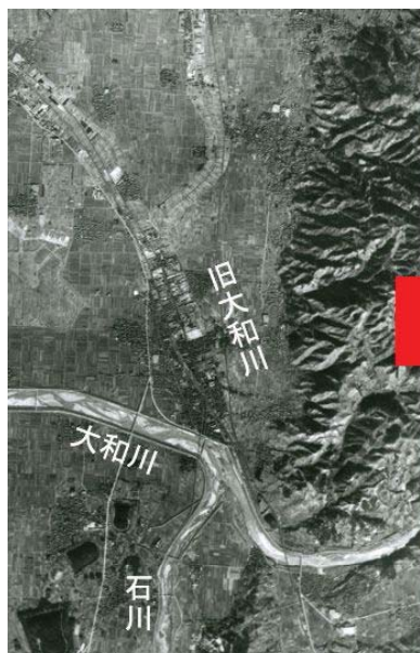
大和川付け替え地点 昭和26年米軍撮影 元の川筋がはっきりわかる
