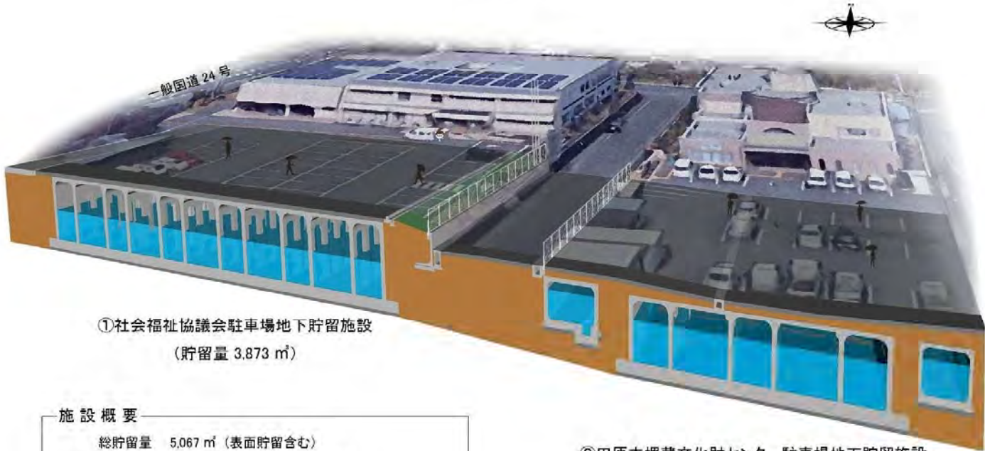
②田原本埋蔵文化財センター駐車場地下貯留施設 (貯留量 1,127 m 3 )
